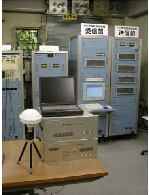
図 1 定常観測用のイオノゾンデ（右奥）と FMCW イオノゾンデ（手前、机の上）
