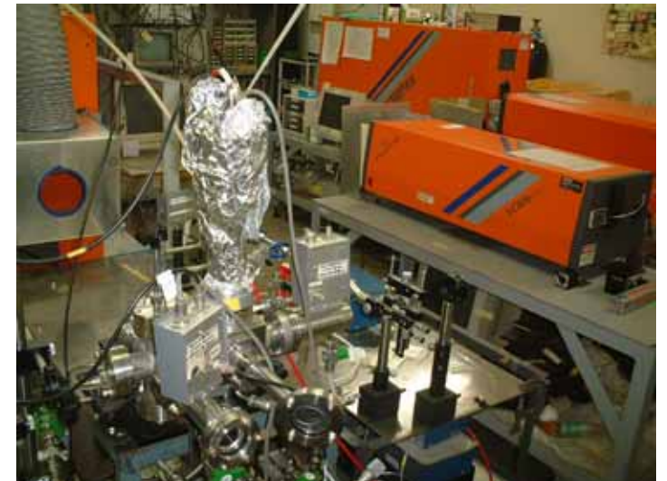
レーザーを用いた反応過程分析装置。太陽活動変動の顕著な現れである太陽紫外線の強度変動が大気組成に与える影響を解明するために、室内実験により紫外短波長域での光化学反応の素過程を明らかにし、モデル計算に反映させます。
