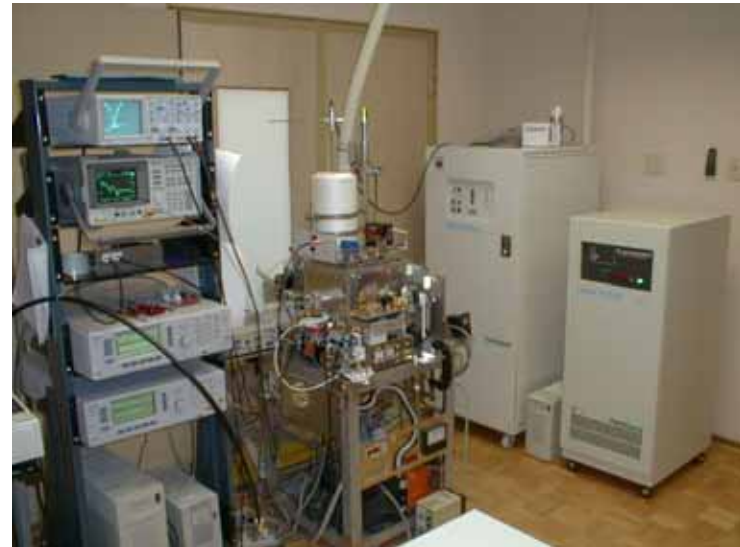
高感度ミリ波大気観測装置。つくば、陸別(北海道)、チリ(南米)などで、数年から十数年のタイムスケールで大気組成の変動を観測し、太陽の11年周期の影響による変動を抽出します。
